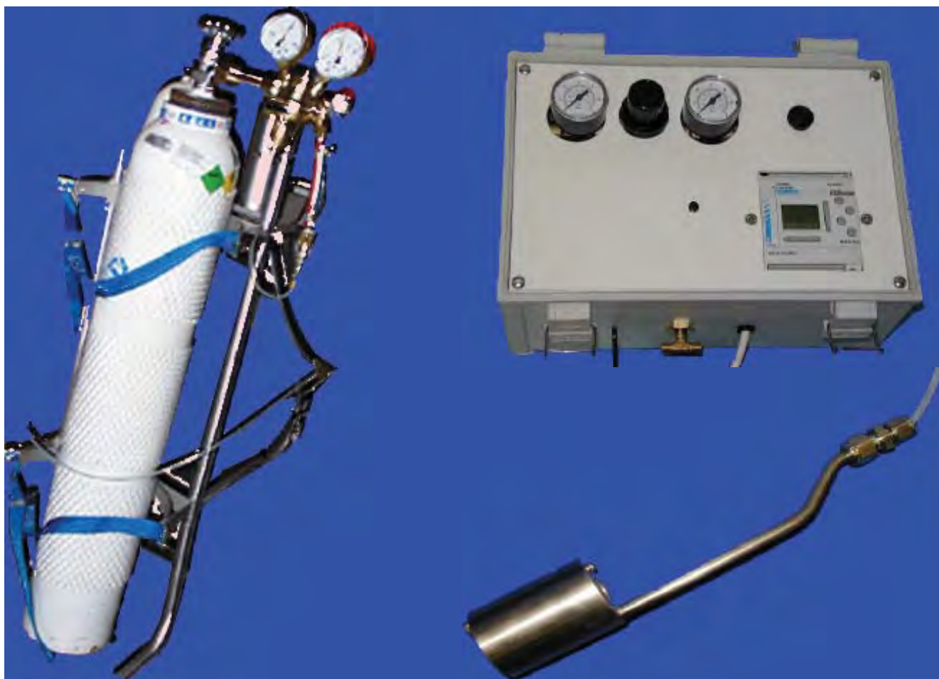
Abbildung 3: Mikro-Oxygenator Compact (Oenodev) zur Begasung eines Tankes mit Sauerstoffflasche, Steuereinheit und Edelstahlfritte
