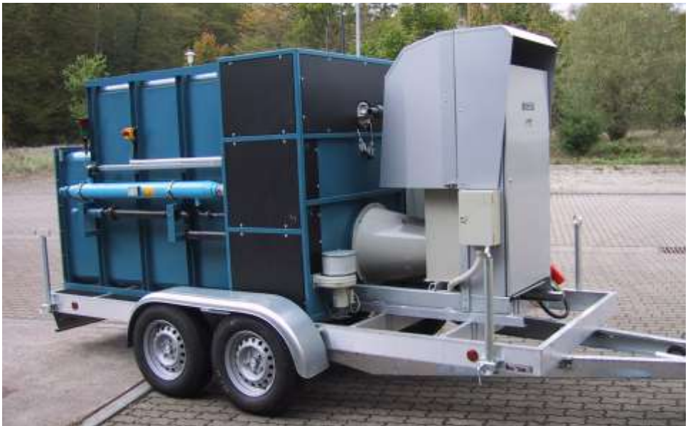
Abb. 1: Mobile Anlage KEA-WEIN zur Maischeporation
